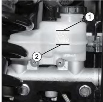
3. Liegt der Flüssigkeitsstand unter der Maximalmarke, die Kühlerhaube öffnen und Bremsflüssigkeit bis zur Maximalmarke (MAX) nachfüllen.
