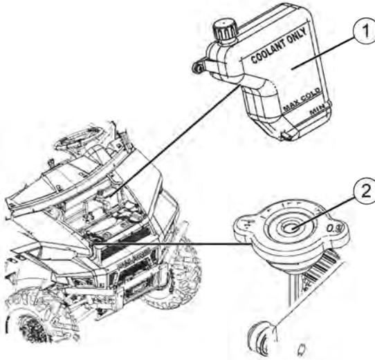
3. Liegt der Kühlmittelstand unterhalb des betriebssicheren Bereichs, Kühlerhaube öffnen und Ausgleichsbehälterdeckel ausfindig machen. Deckel abnehmen und Kühlmittel, mit einem in die Einfüllöffnung gesteckten Trichter, nachfüllen. Deckel wieder aufsetzen.
