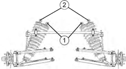
3. Die Stoßdämpfer-Befestigungsschrauben wieder einbauen. Auf ein Drehmoment von 54,2 Nm (40 ft-lb) anziehen.
