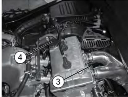
17. Ölmesstab wieder vollständig einführen. Messstab wieder herausziehen und Ölstand ablesen.
