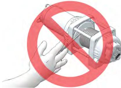
18. Nie die Windenkupplung freigegeben, solange das Windenseil unter Spannung steht.
