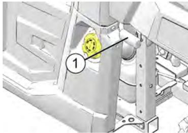
7. Anschließend die Pritsche wieder herunterklappen und fest nach unten drücken, so dass sie einrastet.
