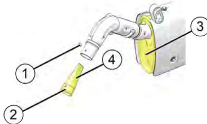
4. Das Sieb auf Abnutzungserscheinungen und Schäden prüfen. Wenn es abgenutzt oder schadhaft ist, ein neues Sieb einbauen.
