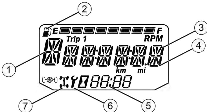
In der Werkseinstellung zeigt der Anzeigeblock US-Maßeinheiten und die Uhrzeit im 12-Stunden-Format an.
