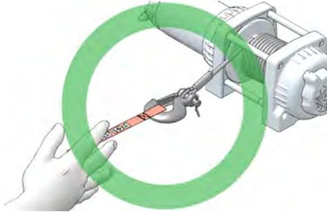
4. Verwenden Sie zum Hantieren mit dem Haken stets den Hakengurt.
