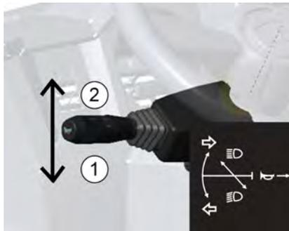
Zum Abschalten des Blinksignals den Hebel wieder in Mittelstellung bringen.
