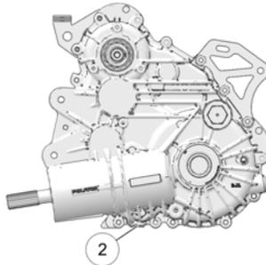
3. Ablassschraube herausdrehen. Flüssigkeit vollständig ablaufen lassen.
