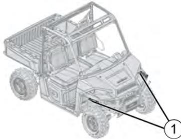
Sollte (entgegen unseren Empfehlungen) ein Hochdruckreiniger zum Abspritzen des Fahrzeugs verwendet werden, ist äußerste Vorsicht geboten. Das Wasser kann Bauteile beschädigen, das Absplittern von Lack bewirken und Aufkleber ablösen. Den Wasserstrahl nicht auf folgende Stellen richten:
