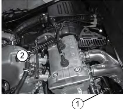
9. Einfülldeckel wieder anbringen. Ölmesstab wieder einsetzen.
