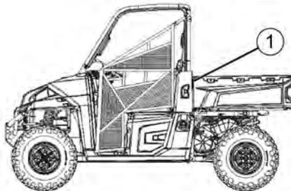
Die Siebe ① vor jedem Gebrauch des Fahrzeugs kontrollieren. Jeglichen Schmutz und Rückstände von den Sieben entfernen und diese häufig mit warmem Seifenwasser waschen.
