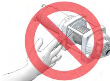
18. Nie die Windenkupplung freigeben, solange das Windenseil unter Spannung steht.
